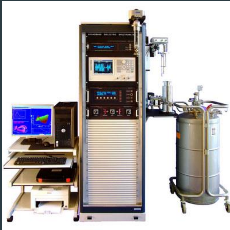
Ультранизкополосный диэлектрический спектрометр с криосистемой Novocontrol BDS80
