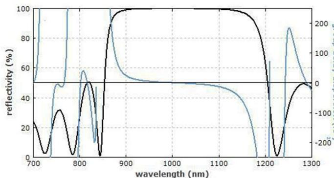
Поскольку фазовый набег зависит от частоты, декремент затухания и коэффициент отражения падает при изменении длины волны, а вне некоторой полосы экспоненциальное затухание сменяется осциллирующим режимом.
